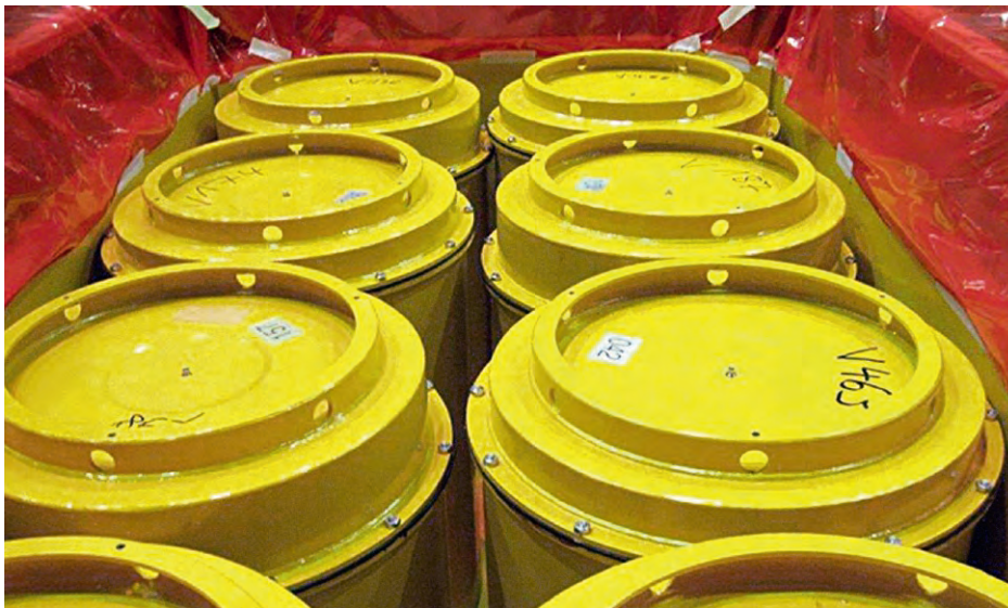
Überfässer mit Verdampferkonzentratfässern eingestellt in Konrad-Container Typ IV.
