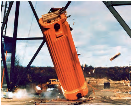
BAM-Testgelände in Lehre 1978: Erste 1:1-Falltests mit einem CASTOR® Ia Prototyp.
