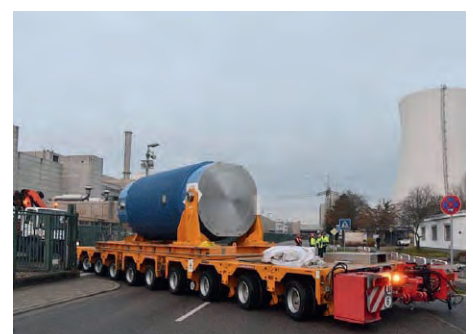
Der 17. CASTOR® V/52 mit den letzten BE des KKP 1 auf dem Weg ins KKP-Standortlager.
