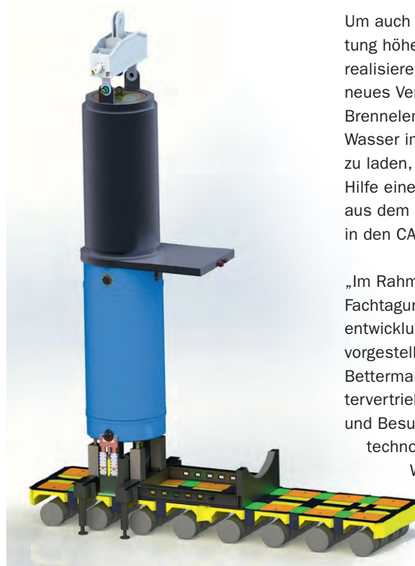
Die „Cask Loading Unit“ (CLU) wird außerhalb des Beckens auf den CASTOR® aufgesetzt.
