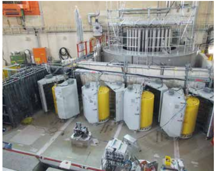
Trocknung der beladenen MOSAIK®-Behälter mit der GNS-Anlage KETRA.
