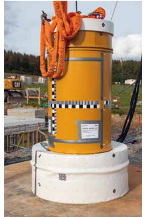
Prüfmuster nach dem 9 m-Deckelflachfall.
