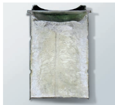
Weder Hohlräume noch Nester: Schnitt durch eines der während des Probebetriebs hergestellten Fässer
