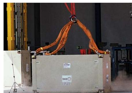
Fallprüfung mit Fallhöhe 5,0 m; Stahlblechcontainer SC Typ V neu der GNS für ABK I/II störfallfest
