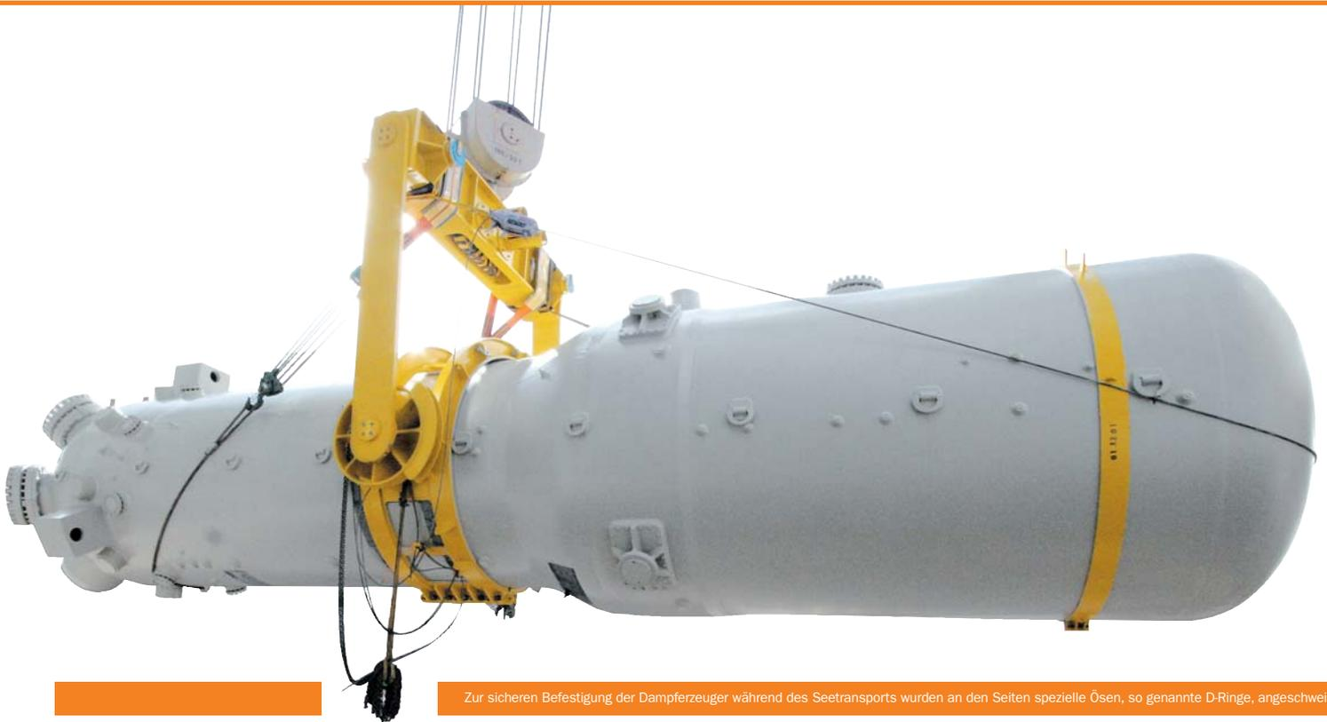
Zur sicheren Befestigung der Dampferzeuger während des Seetransports wurden an den Seiten spezielle Ösen, so genannte D-Ringe, angeschweißt.
