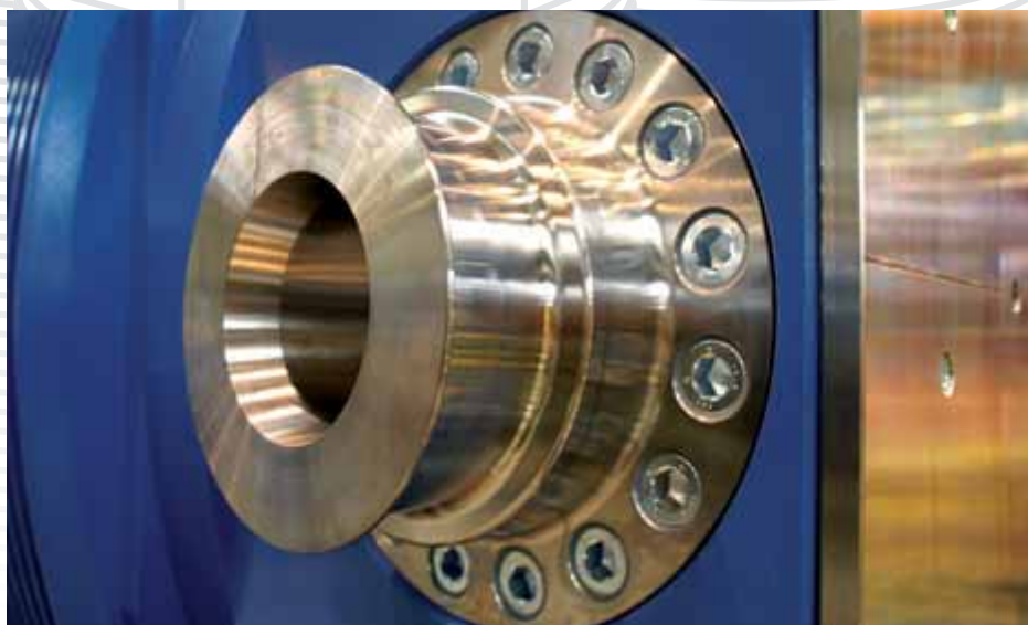
Tragzapfen und durchgehende Bodenplatte eines CASTOR® V/19 gemäß den IAEA-Regularien von 1996
