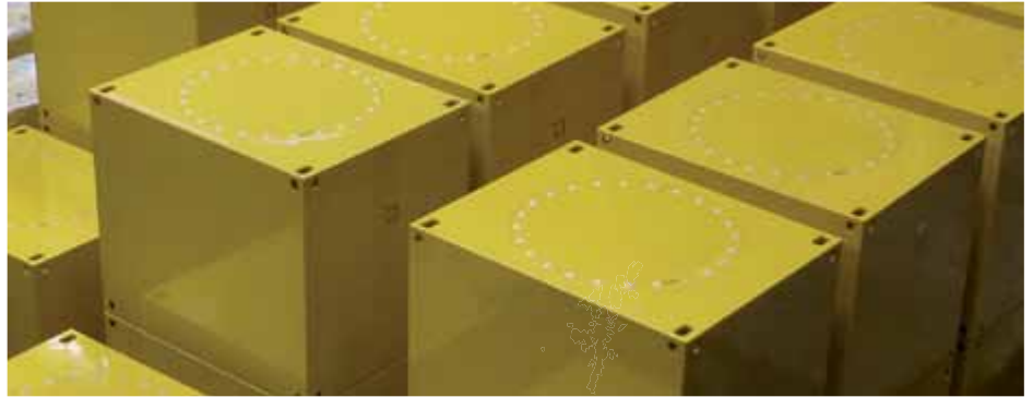
Die ersten dort als „GNS YELLOW BOX“ vertriebenen Gusscontainer für England sind bereits gefertigt.
