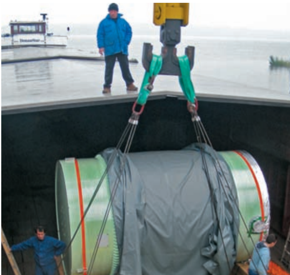
Entladung des ersten CONSTOR®-Behälters im Hafen des Kraftwerks Kozloduy
