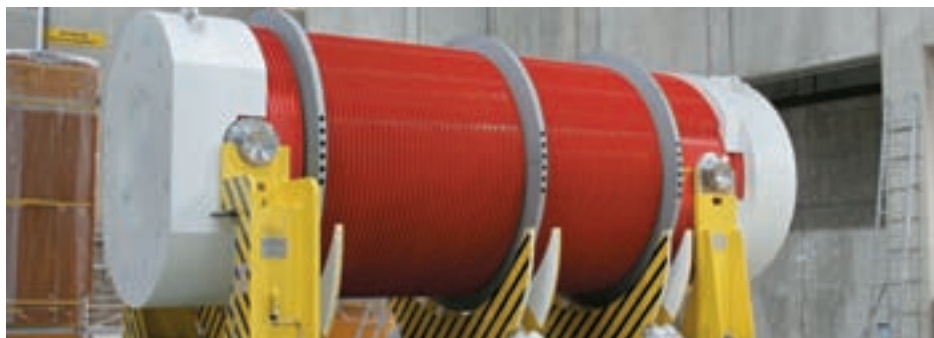
Ein CASTOR® HAW28M mit den für den Transport erforderlichen Boden-, Deckel- und Mantelstoßdämpfern bei der Kalthantierung in Gorleben
