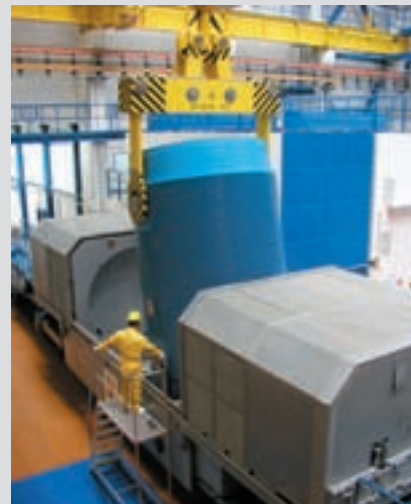
CASTOR® 440/84M beim Umladen im Zwischenlager Dukovany
