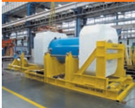
Vorbereitungen für den Transport des ersten CASTOR® KNK zur Kalthantierung
