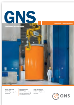
Titel: Einlagerung des ersten CONSTOR® RBMK1500/M2 im Zwischenlager des litauischen Kernkraftwerks Ignalina
