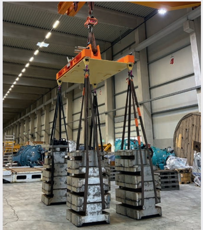
Die KC-Spreader haben den 30-Tonnen-Überlasttest mit Bravour bestanden.
