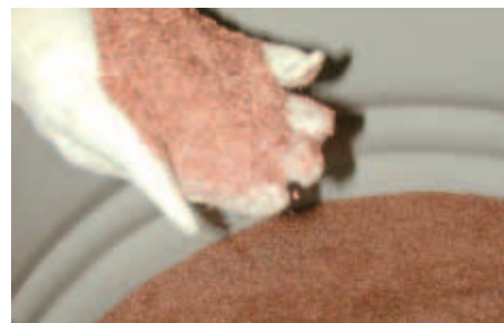
...aus Kabelschrotten wieder verwertbares...
