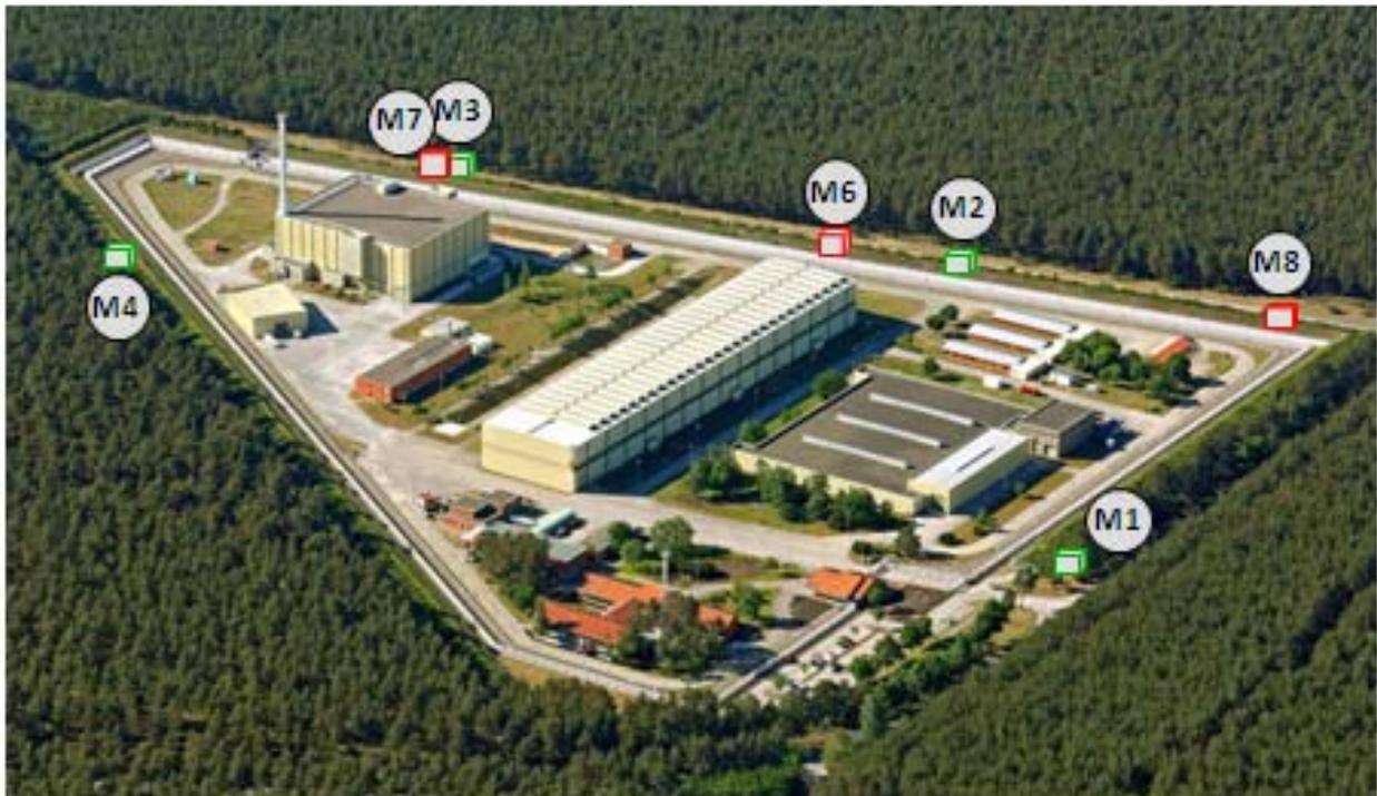
Abb. 1: ODL-Messstationen am Werkszaun
