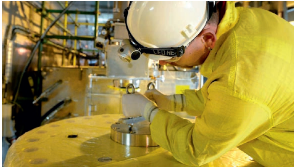
Abnahme des MOSAIK®-Verschlussdeckels zum Anschluss an die FAFNIR.
