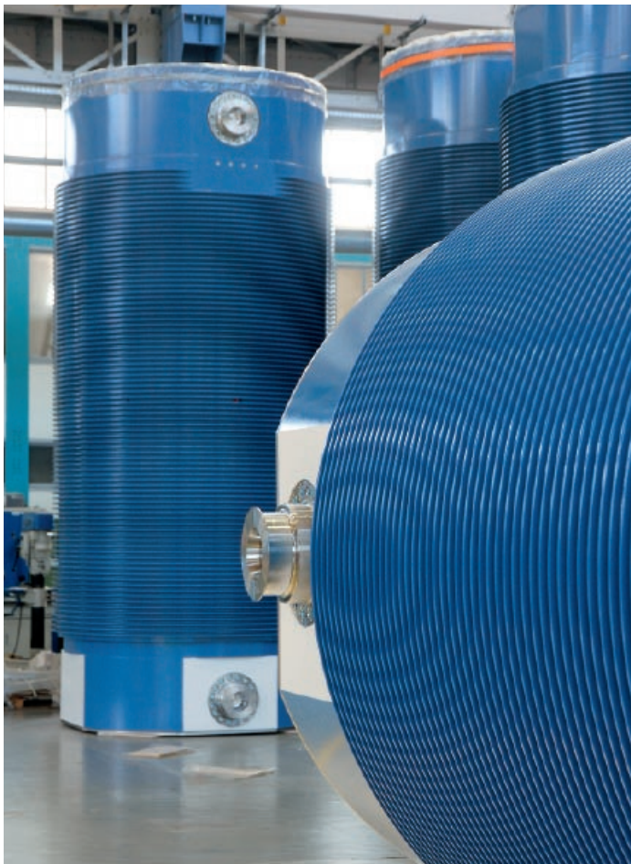
Die ersten fertigen CASTOR® V/52 in der GNS-Betriebsstätte in Mülheim neben den rund einen halben Meter höheren Behältern vom Typ CASTOR® V/19.
